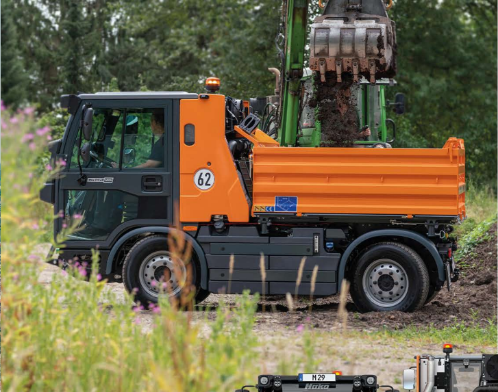
Multicar M29 6t-Klasse, allradgelenkt, Wendekreis von 3,25 m, bis zu 3150 kg Nutzlast
