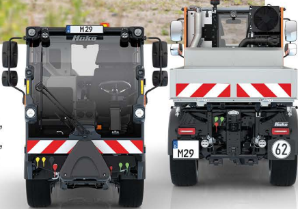
Multicar M29 6t-Klasse, allradgelenkt, Wendekreis von 3,25 m, bis zu 3150 kg Nutzlast
