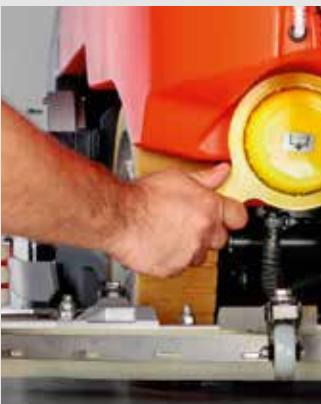
Extrem wendig: Mit einem Lenkradeinschlag von 90 Grad und einem Wendekreis von nur 179 cm ist die Reinigung von Ecken, schmalen Gängen und Fluren kein Problem – ein weiterer Pluspunkt in Sachen Flexibilität.
