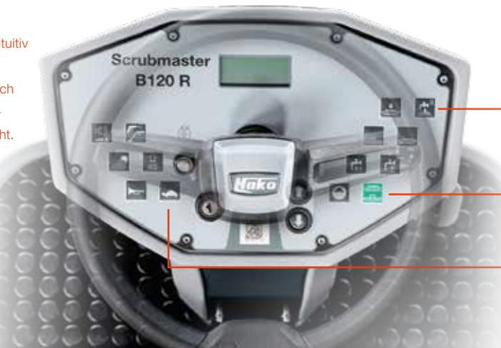
Die Boost-Taste aktiviert die maximale Wasserstufe und den vollen Bürstendruck.
