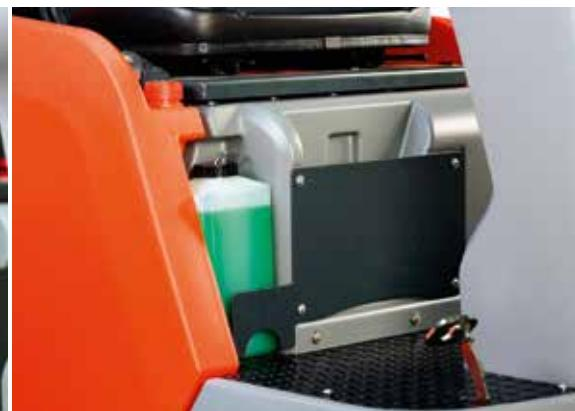
Das On-Board-Dosiersystem sorgt in Abhängigkeit von der Wasserzufuhr für eine optimale Zugabe des Reinigungsmittels – vollständig integriert im Maschinendesign.
