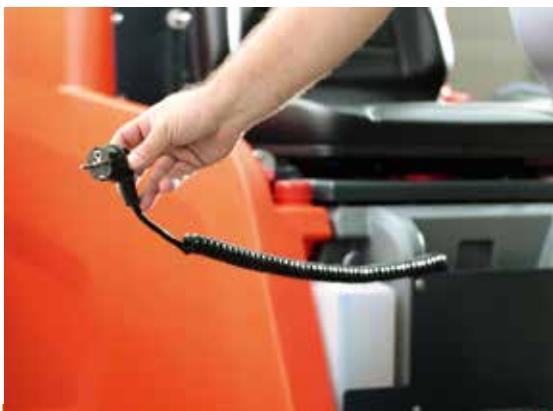
Mit dem On-Board-Ladegerät kann die Batterie an jeder herkömmlichen 220/230V-Steckdose aufgeladen werden.
