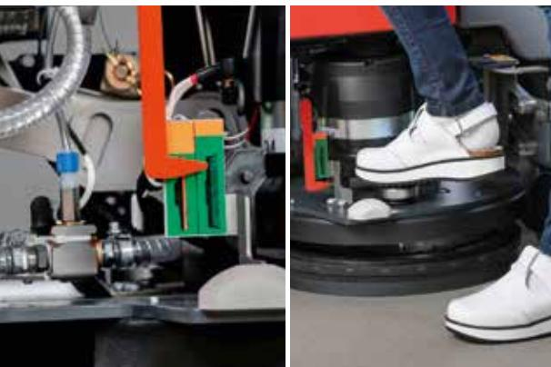
Immer im Überblick: Verschleißanzeige für Bürsten und Pads. Komfortabler Abwurfmechanismus für den einfachen, schnellen Bürstenwechsel – ganz ohne Werkzeug.
