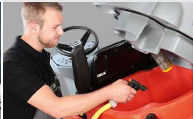
Glatte Flächen im Tank: Das vereinfacht die Tankreinigung und verhindert die Ablagerung von Schmutzresten.
